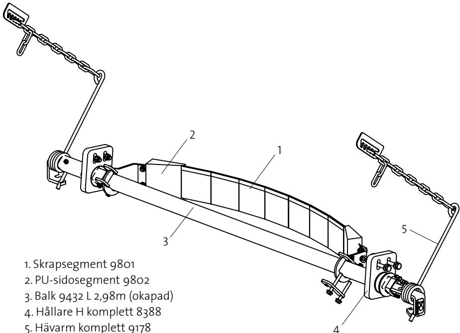
Alla stål detaljer är el-galvaniserade som standard.
